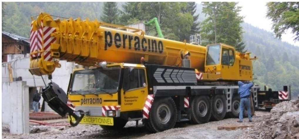
Photo 11: Grue mobile de forte capacité : exemple : Grue 180 T à 2,50m , flèche 60m
