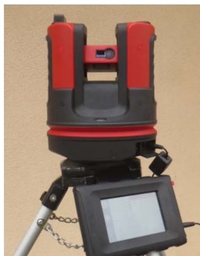
Photo 35: Station de mesure laser
