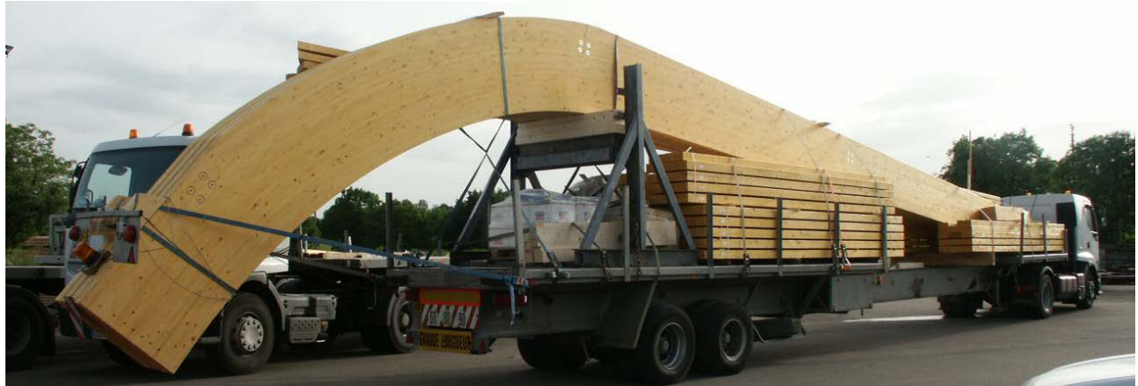
Photo 5 : Convoi de 3 ème catégorie : hauteur 4,70m, longueur 26m
