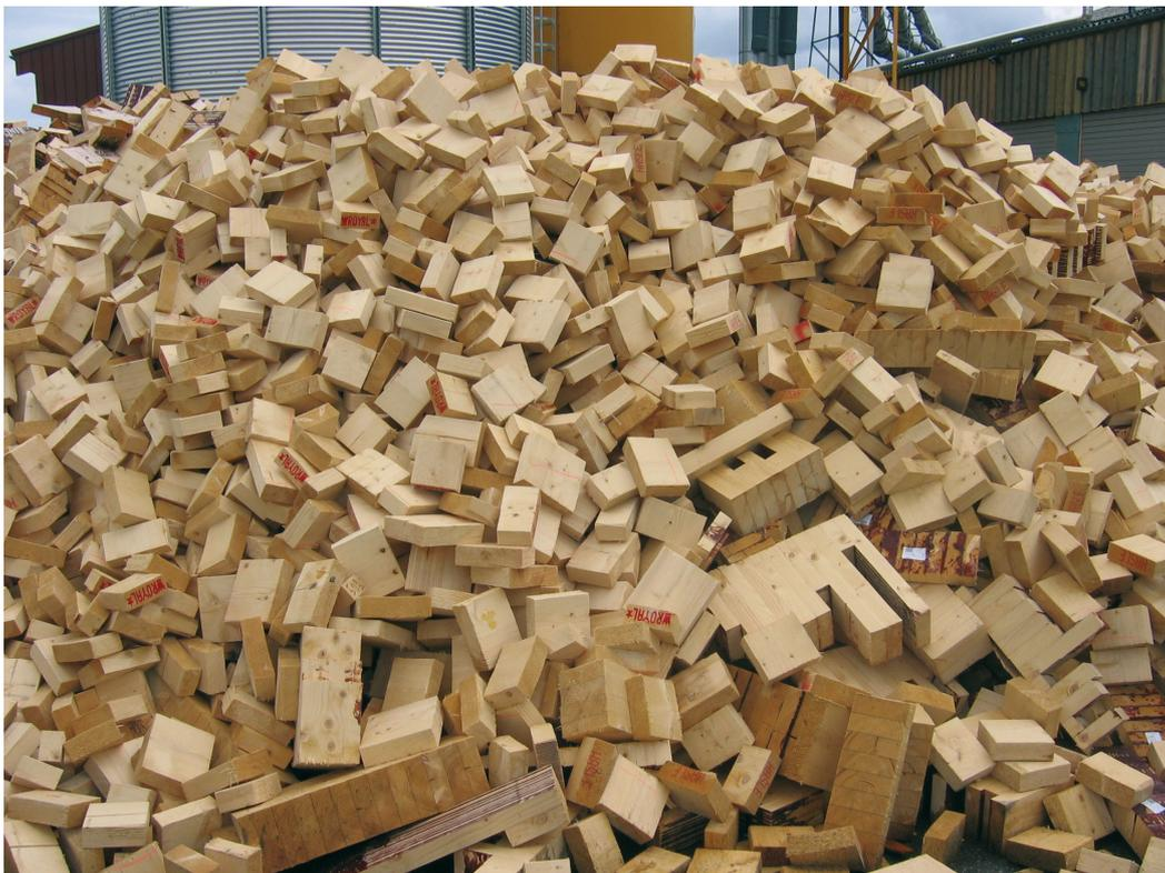
Figure 1.7 : Récupération des chutes de bois lors de la fabrication pour valorisation énergétique.
