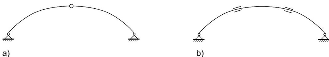
Figure 11.3 : Emplacement adéquat d'assemblages dans des arcs : a) arc à trois articulations ; b) arc à deux articulations.
