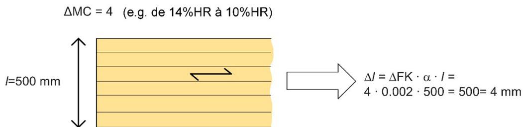
Figure 14.3 : Illustration de l'amplitude du retrait dû à la dessiccation d'une poutre en bois lamellé-collé.
