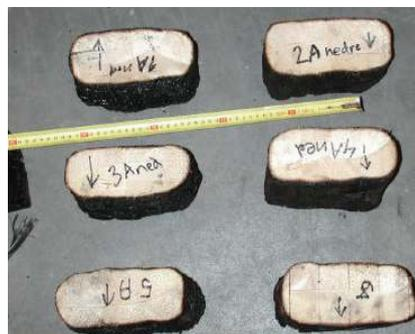
**Le bois lamellé collé conserve donc longtemps ses caractéristiques mécaniques et son comportement sous charges ne dépend que de sa section nette non détruite par le feu. On considère ainsi le bois lamellé collé comme un matériau fiable et prévisible vis-à-vis de sa résistance au feu.**
